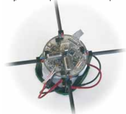
Le cœur de X4: 3 accéléromètres intégrés et un cerveau compact.
