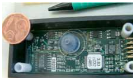
Projet de centrale d'attitude intégrée pour micro-drones : 3 \mu -accéléromètres, 3 \mu -gyromètres, 1 magnétomètre, 1 niveau + capteurs de pression différentielle et absolue.
